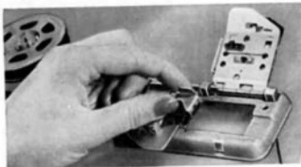
Mit der Schabeeinrichtung feilen Sie die Schicht ab, aber nur soviel, bis die bearbeitete Fläche hell durchsichtig wird. Den letzten Feilstrich machen Sie nach unten, d. h. gegen sich, damit mit Sicherheit der Film am Anschlag anliegt.
