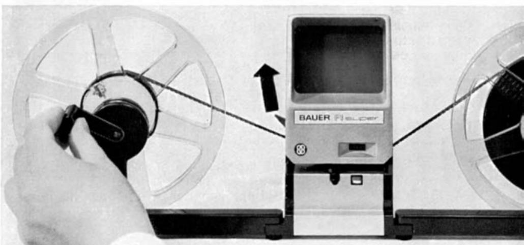
Lampenwechsel: Lampenhausdeckel nach vorne abziehen und Lampenabdeckung nach Lösen der Schraube abnehmen. Lampe nach links drehen und herausziehen (6 V/10 W Autolampe, BA-15 S Bajonettsockel). Zur optimalen Ausleuchtung kann die neue Lampe wahlweise in drei verschiedenen Rastungen eingesetzt werden (hineindrücken und nach rechts drehen).
