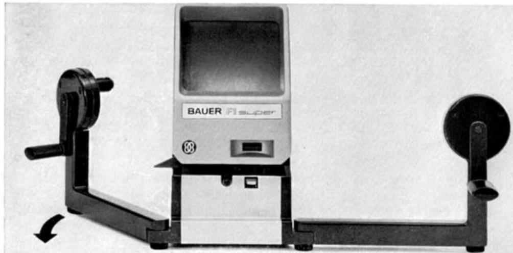
Filmspulen auf die Spulenarme stecken: Leerspule rechts, volle Spule links (Filmpförlation nach vorne, Filmschicht - matte Seite - nach oben). Der Rückspulhebel muß unten stehen (Pfeil). Film in die Filmbahn einführen - Filmanfang an der Aufwickelspule einhängen.
