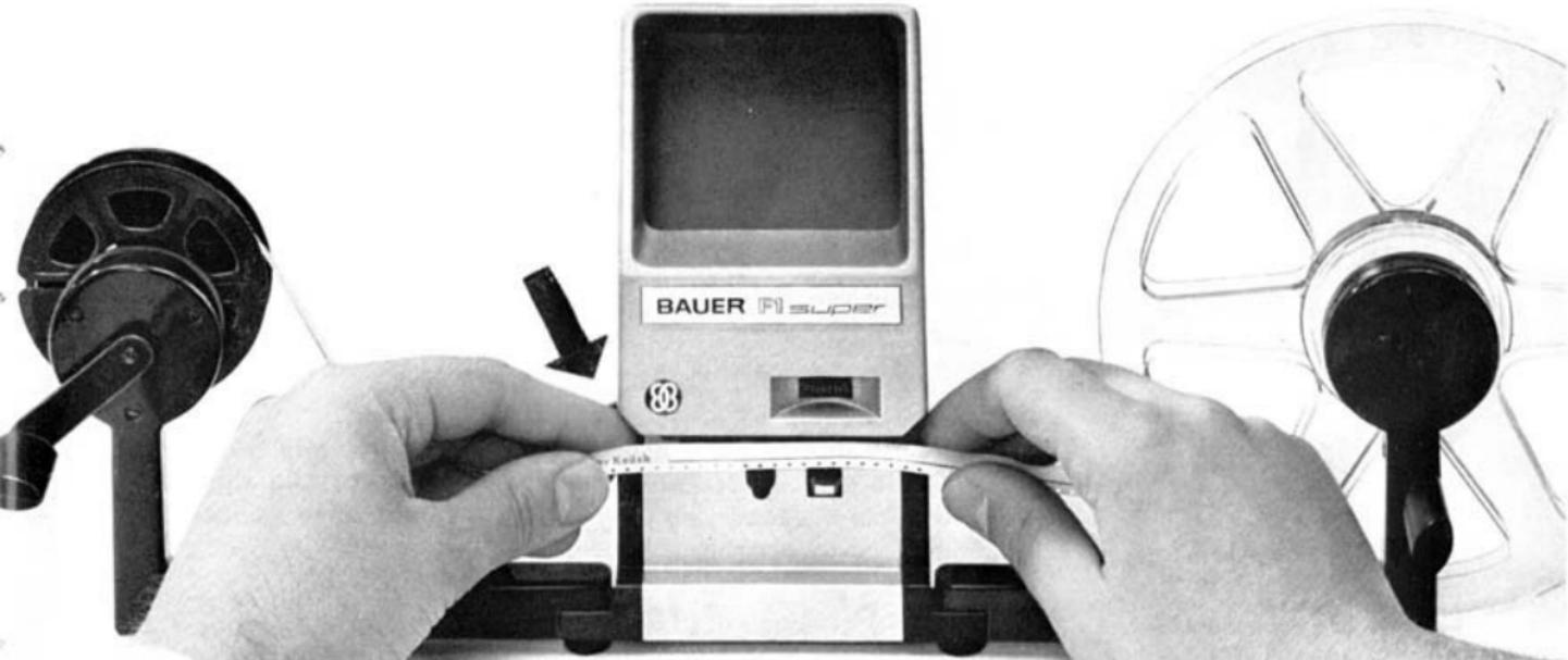
Licht einschalten und rechte Kurbel im Uhrzeigersinn drehen - die erste Filmszene erscheint auf der Mattscheibe. Bild am Rändelrad scharfstellen. Zur genauen Einstellung einzelner Bilder kann die Filmtransportrolle nach links oder rechts gedreht werden.
