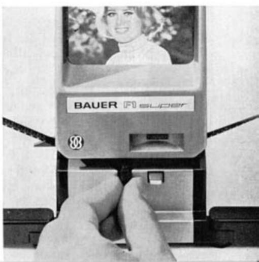
Filmschnittstellen mit der Stanze markieren; Film abschneiden und in die Klebepresse einlegen. Rückspulung: Rückspulhebel nach oben stellen (Pfeil) und Film durch Linksdrehung der linken Kurbel rückspulen (3fache Übersetzung).
