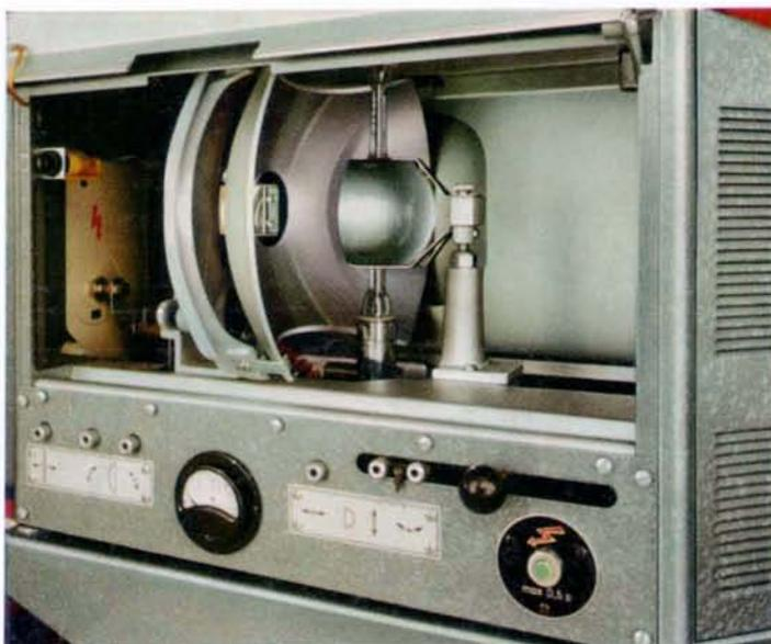
Der Projektor kann bei geringerem Lichtbedarf auch mit einem Halogenlampenhaus betrieben werden (Fotos unten). Neben den für den Betrieb der 24-V-Halogenlampe erforderlichen elektrischen Einrichtungen enthält dieses Lampenhaus eine Automatik für den selbsttätigen Lampenwechsel bei Bruch des Glühfadens. Der Wechsel auf die Reservelampe erfolgt so schnell, daß der Zuschauer keine Unterbrechung der Vorführung wahrnimmt.
