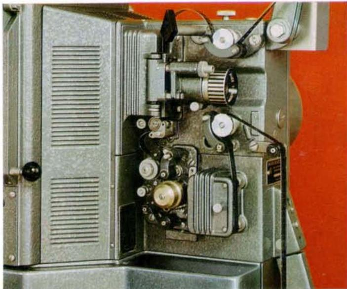
Das Projektorwerk transportiert den Film mit äußerster Präzision. Der Bildstand ist hervorragend. Das Malteserkreuzgetriebe läuft im Ölbad; das Schaltverhältnis 1 : 4 garantiert äußerste Schonung des Films. Die Bedienung ist einfach und entspricht den Erfordernissen der Praxis.
