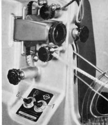
Abb. 7 Richtig eingelegter Film im T10- Projektor 1 Motorschalter 2 Lampenschalter
